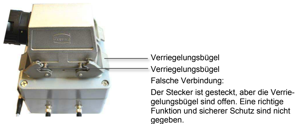
Abb. 3-13 Falsch: Verriegelungsbügel geöffnet
